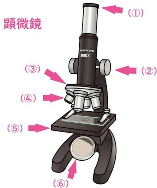
1. 顕微鏡は 40~600 倍程度で物を観察する。顕微鏡の各部分の名称を答えよ。顕微鏡は (6) としぼりを調節し、視野を明るくする。プレパラートを (5) の上にのせて、横から見ながら (2) を回し、(4) をプレパラートに近づける。(1) をのぞき、(4) とプレパラートを遠ざけながらピントを合わせる。
